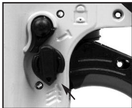
Mode de déclenchement sur contact (sélecteur de mode de déclenchement pointant vers le bas)
